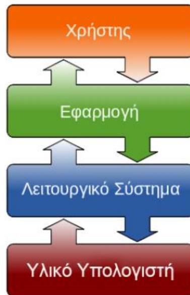
Τυπική διαστρωμάτωση λογισμικού.
