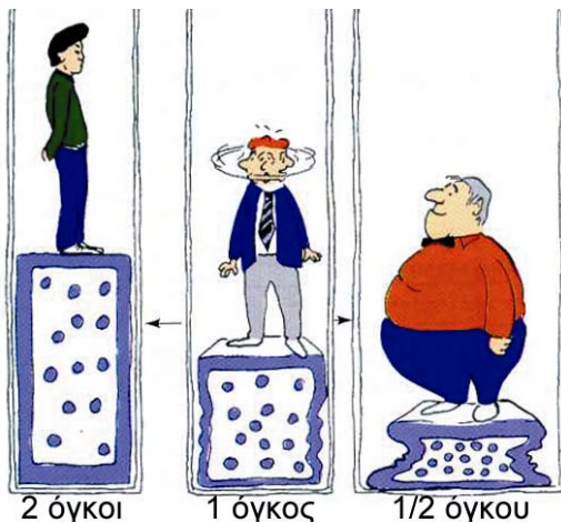
ΣΧΗΜΑ 4.3 Εικονική παρουσίαση του νόμου του Boyle. Ο όγκος του αερίου είναι αντιστρόφως ανάλογος της πίεσης (με n, T σταθερά).
