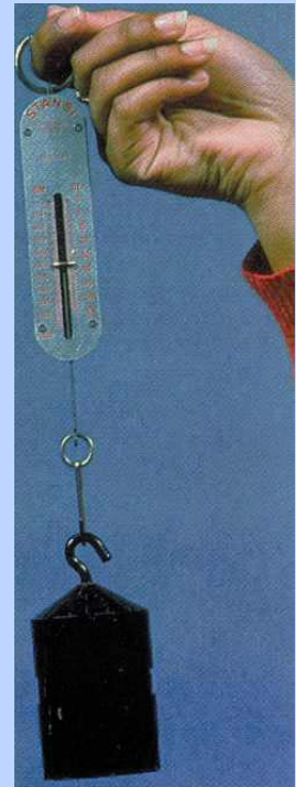
Το δυναμόμετρο είναι όργανο μέτρησης βάρους.
